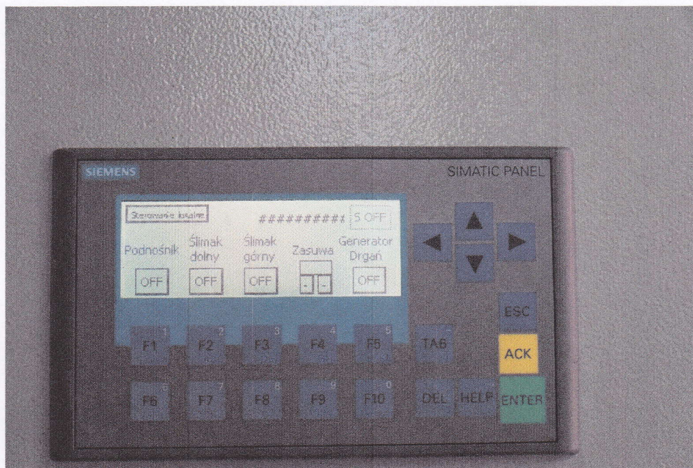
Pic.3 Stanowisko badawcze nowej wagi - panel operatorski
